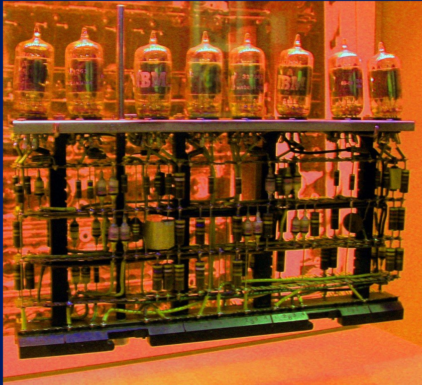
Aspecto interno de circuitos com válvulas
